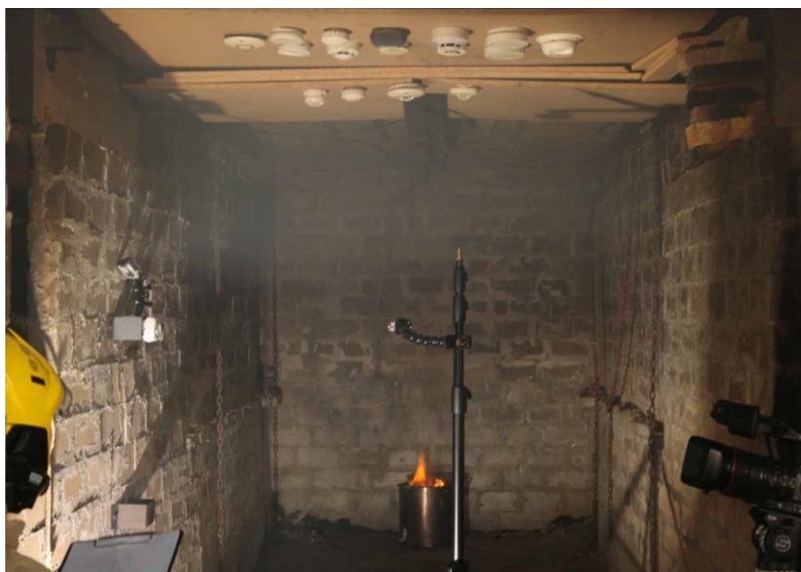
图 4—内部进行的各种独立火警侦测器测试
